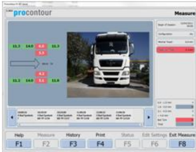
Bild 1: Das Reifendaten-Netzwerk Classis wertet Reifeninformationen im fließenden Verkehr vollständig aus
