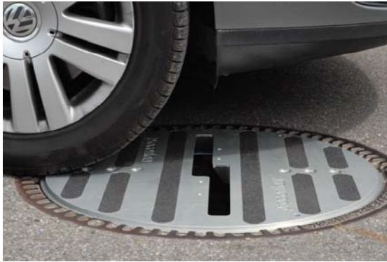
Abb.: Ein Reifen fährt über das Messgerät ProContour H3-D jure
