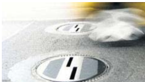
Abbildung 1 - Reifenprofilmessung im Vorbeifahren: Schachtdeckel mit darunter eingebautem ProContour-Messgerät.
