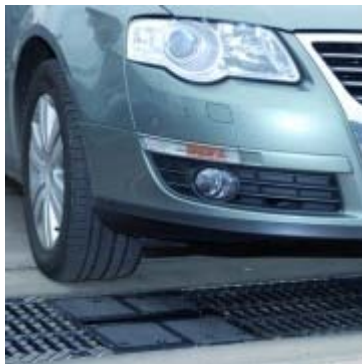
Das ProContour H3-D Causa misst sekundenschnell und vollautomatisch die Profiltiefe. Foto ProContour
