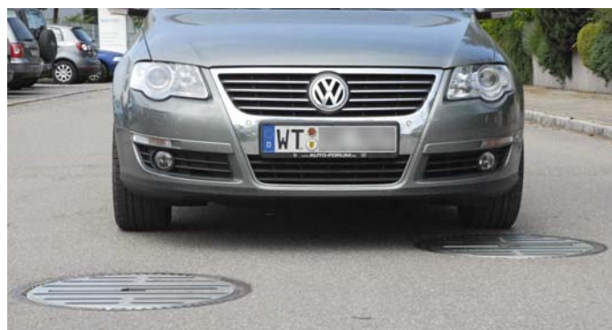
> Zwei Messgeräte eingelassen in zwei Schächte.
