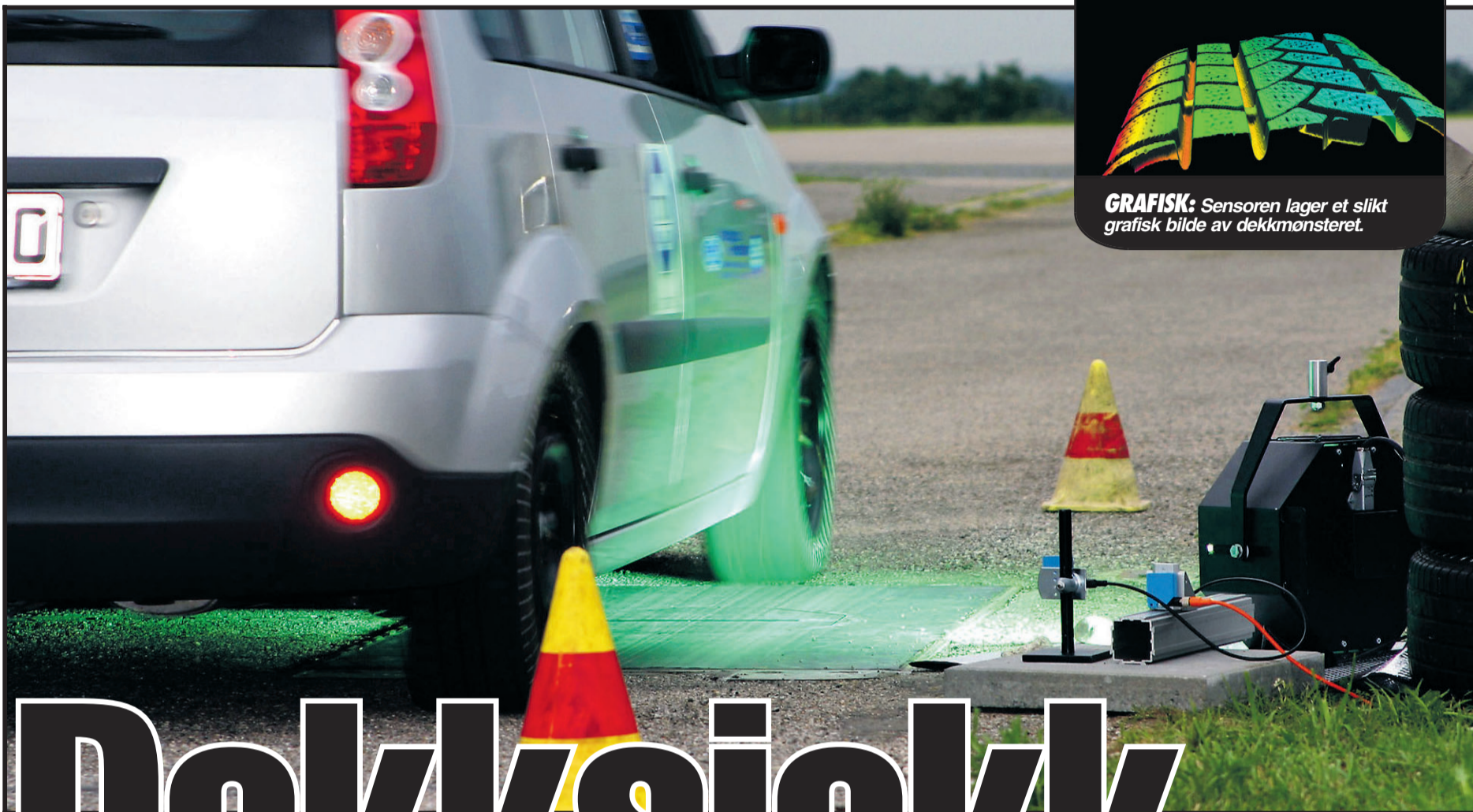
SENSOR: En sensor i veibanen måler automatisk dybden i dekkmønsteret på bilen som passerer. Er mønsterdybden for dårlig går den alarm, slik at bilen kan stoppes. Foto: PROCONTOUR
