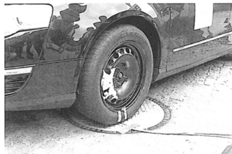
Bei der mobilen Variante des Profiltiefenmessgerätes können zwecks Unterbringung der in der Fahrbahnebene benötigten Komponenten der Anlage beispielsweise vorhandene Kanaldeckel entsprechend umfunktioniert werden
